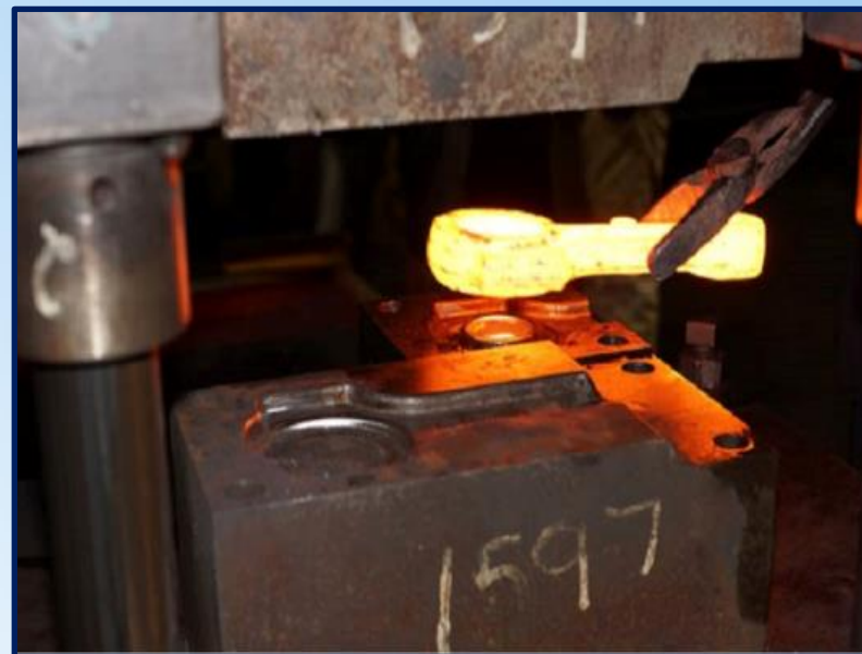
Esempio di operazione di forgiatura a stampo chiuso
