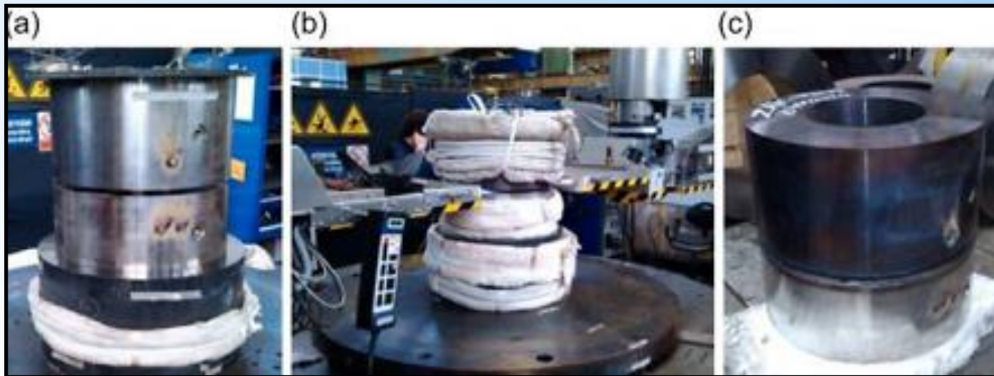
prove di saldatura disomogenea A263 + COST F Ø500 mm.
