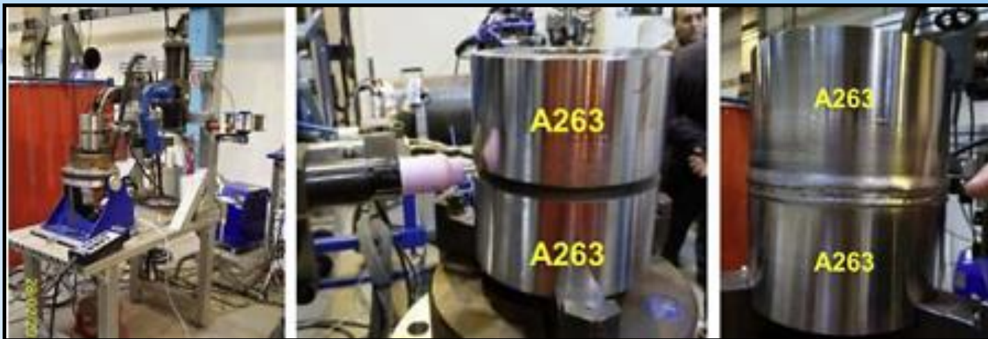
A263: prove di saldature omogenee
