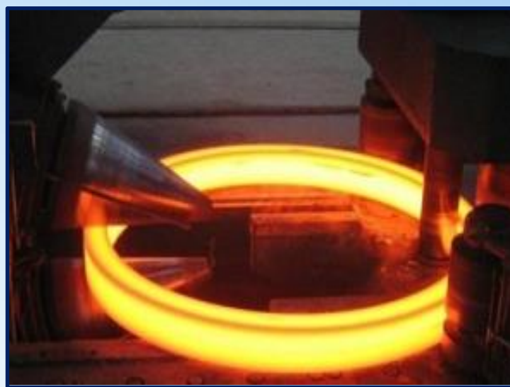
Schema del processo di forgiatura ad anello
